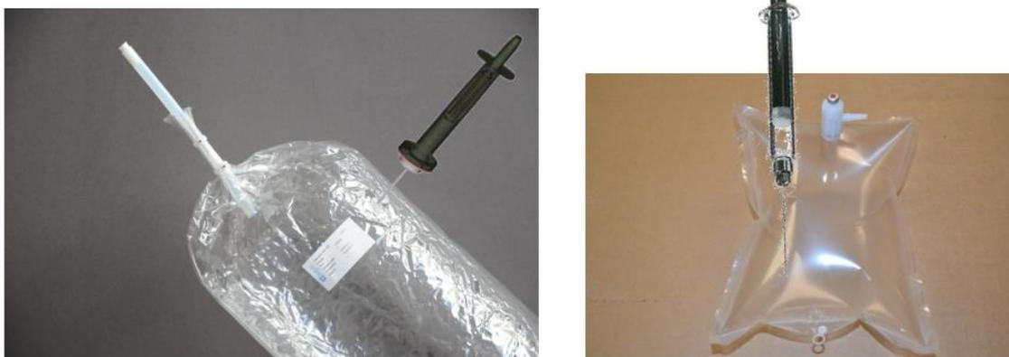
Figure 6.13 : Images de sous-échantillonnage des COV avec une fibre de SPME (gauche) et avec une syringe de gaz (droite)
