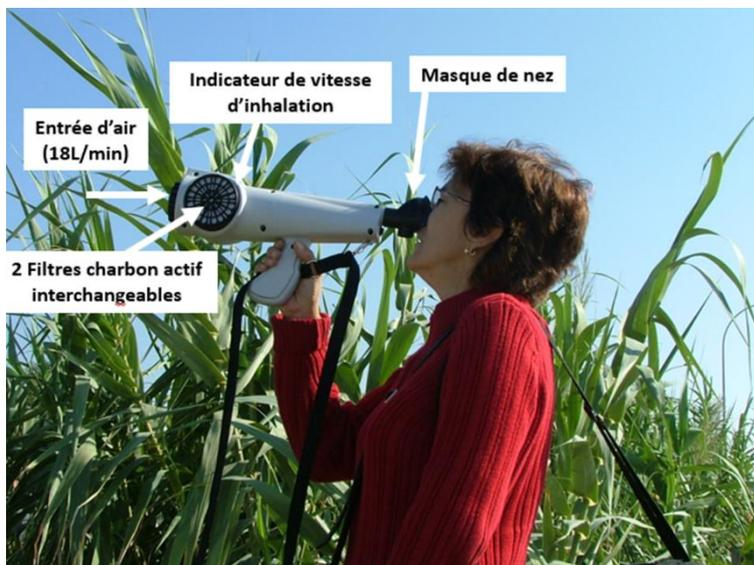
Figure 10.4 : Olfactométrie de terrain avec l'olfactomètre Nasal Ranger™
