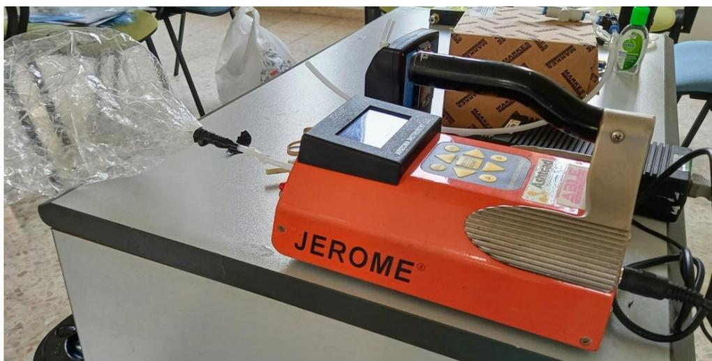
Figura 8.2 : Analyseur portable d' $\text{H}_2\text{S}$  Jerome J605
