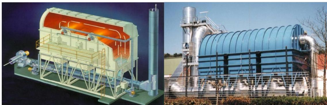
Figure 11.8 : Schéma et exemple d'un système d'oxydation thermique régénérative
