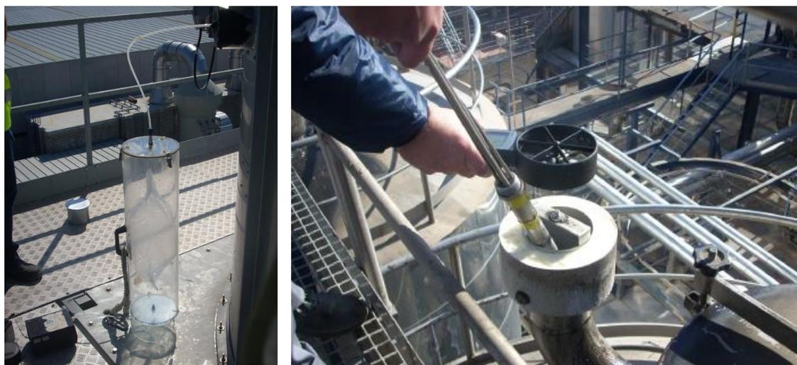
Figure 6.5 : Images de captations d'échantillons pour l'analyse de la concentration d'odeur en émissions canalisées sans dilution
