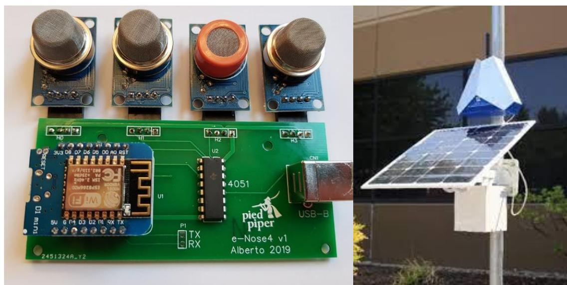
Figure 8.4 : Batterie de capteurs d'un nez électronique (gauche). Installation d'un équipements à faible coût pour l'analyse du  $H_2S$  et du  $NH_3$  dans l'air ambiant (droite)
