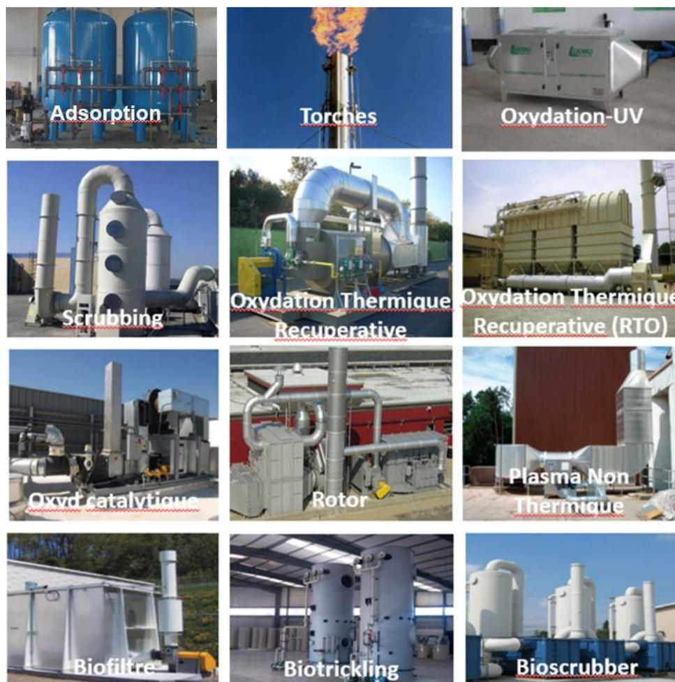
Figure 11.2 : Exemples des technologies d'épuration des émissions d'odeurs et des COV
