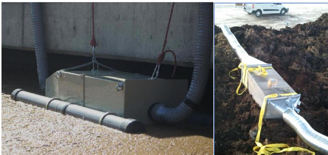
Figure 6.10 : Échantillonnage de l'émission d'un bassin (gauche) et de l'émission d'une pile de fumier de vache
