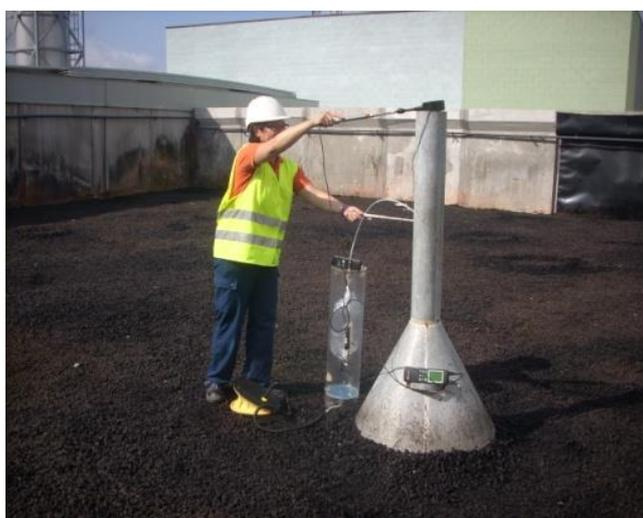
Figure 6.8 : Échantillonnage des émissions de deux STEP : réacteur biologique (gauche) et biofiltre (droite)
