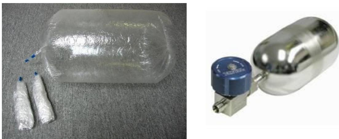
Figure 6.11: Exemples de conteneurs d'échantillons gazeux complets. Sac de Nalophan<sup>TM</sup> (gauche) et canister en inox passivé (droite)
