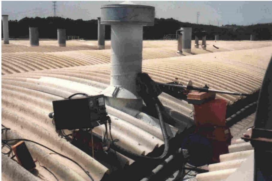
Figure 8.3 : Analyse « in-situ » de COT en une usine alimentaire avec un analyseur FID portable
